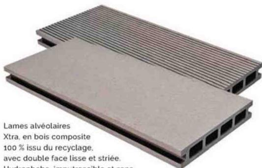
Lames alvéolaires Xtra, en bois composite 100 % issu du recyclage, avec double face lisse et striée. Hydrophobe, imputrescible et sans traitement. Pose murale ou sol. 5 coloris. 340 x 145 cm. Ép. 2,5 cm. ©Lameo
